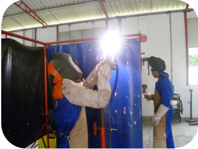
Die ersten Schweisserkurse wurden im Jahre 1999 durchgeführt. Heute werden die Kursteilnehmer an zwölf Schweissplätzen in den Schweissverfahren; Elektrode, Tig und Mig ausgebildet. Besonders geschult wird das Schweißen von Rohren und Schweißen in Zwangslagen wie z. B. Schweißen über Kopf.
